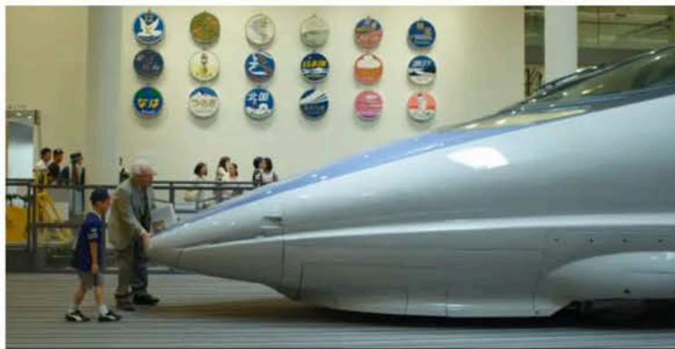
O engenheiro e observador de pássaros Eiji Nakatsu, que usou como referência o formato aerodinâmico da cabeça do martim pescador para redesenhar a locomotiva do trem bala – (David Vêluz/Divulgação)
